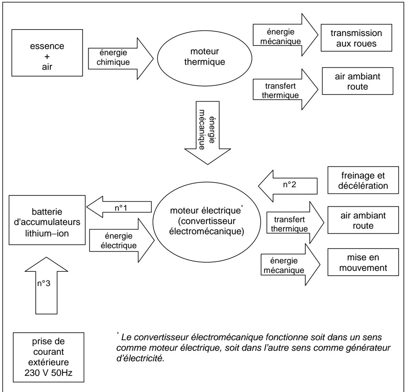
Le scooter dispose d'une motorisation qui associe un moteur thermique et un moteur électrique montés en parallèle, ce qui permet d'augmenter son autonomie.
