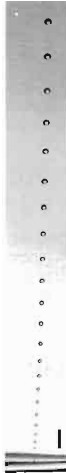
Photographie d'un « train de bulles ». La barre verticale noire mesure 1mm.
